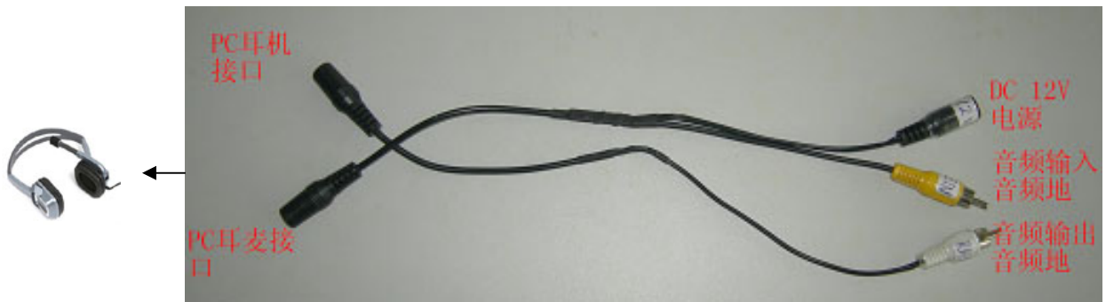
上图为可直接接耳机和麦克的接法，其中右端的接口可以直接接 FH6 中的接口，左端接口相当于 PC 的耳机和麦克接口(上图线内包有转换小板)。
