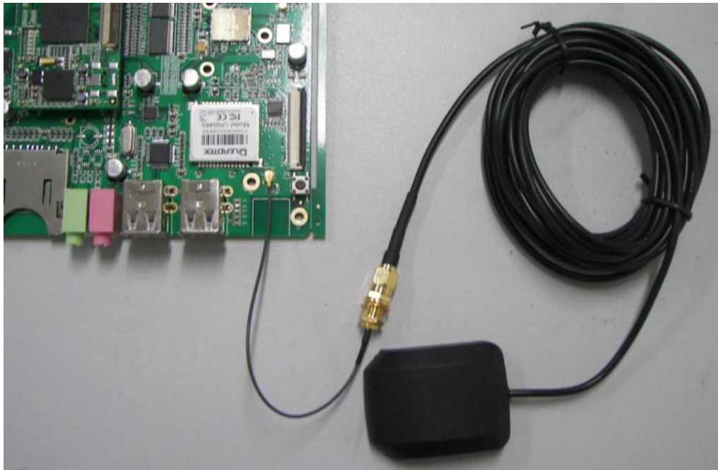
图 2.8 GPS 天线连接方法
